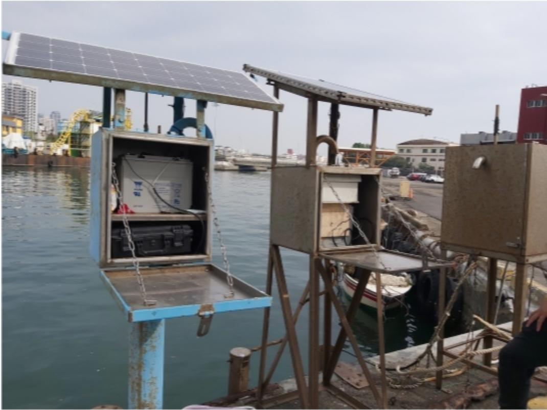
圖 7.2 安平港潮汐測站岸上設備照片
