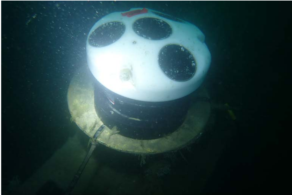
圖 2.2 臺北港波浪測站 AWAC 照片
