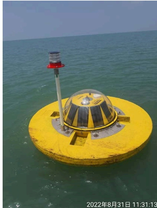
圖 8.2 布袋港海流測站浮球照片
